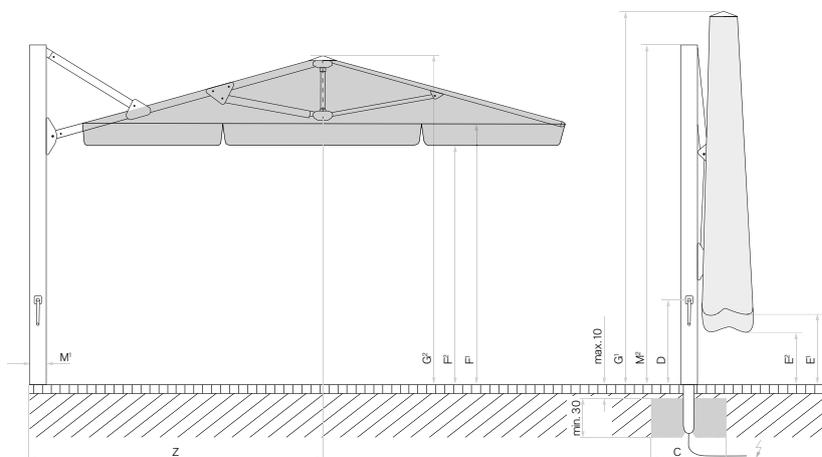
Looser Deckbelag max. 10 cm, Betondicke min. 30 cm (Frosttiefe beachten), Wasserabfluss gewährleisten, Zuleitung elektrisch.
