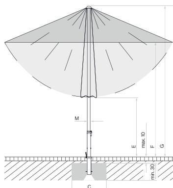
Rivestimento del soffitto sciolto max. 10 cm, spessore del cemento min. 30 cm (rispettare la profondità del gelo), Garantire lo scarico d'acqua
